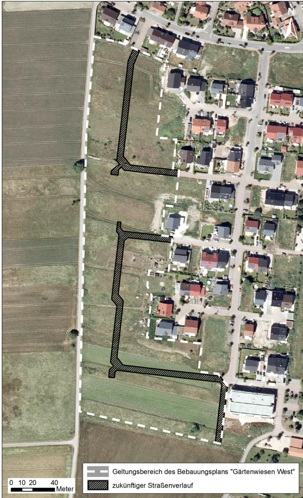
Abbildung 7.1-1. Lage der Erschließungsstraßen innerhalb des Geltungsbereichs des Bebauungsplans.
