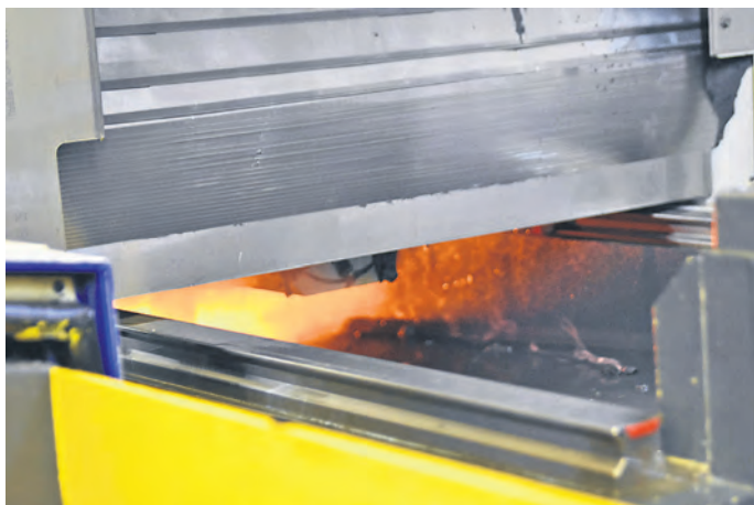
In der Maschine fing das als Kühlmittel dienende Öl Feuer Foto: tcz
